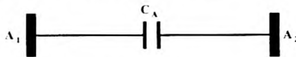
Figura 7.157 Condensadores que intervienen en el circuito de un sensor capacitivo de proximidad cuando el objeto es aislante.
