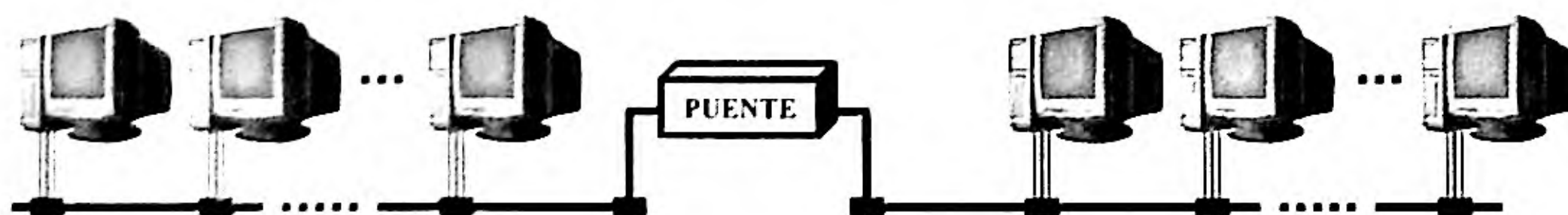
Figura A1.68. División de una red Ethernet en dos mediante un puente ( Bridge ).
