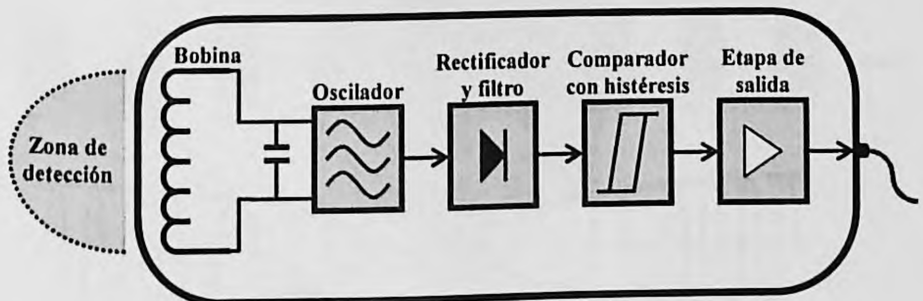
Figura 7.123 Diagrama de bloques de un sensor de proximidad inductivo.
