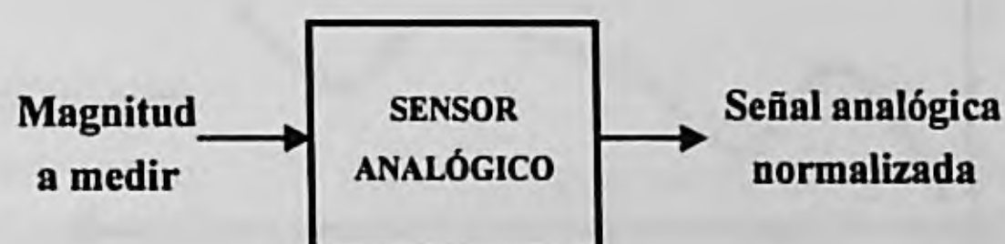
Figura 7.2 Diagrama de bloques de un sensor analógico.
