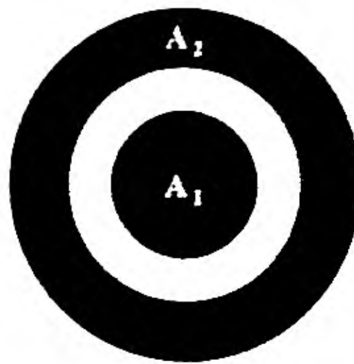
Figura 7. 145 Condensador de placas concéntricas.
