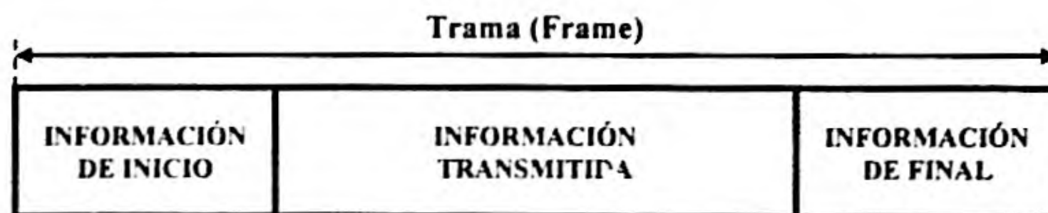
Figura A1.10. Trama ( Frame ) de una transmisión en serie.
