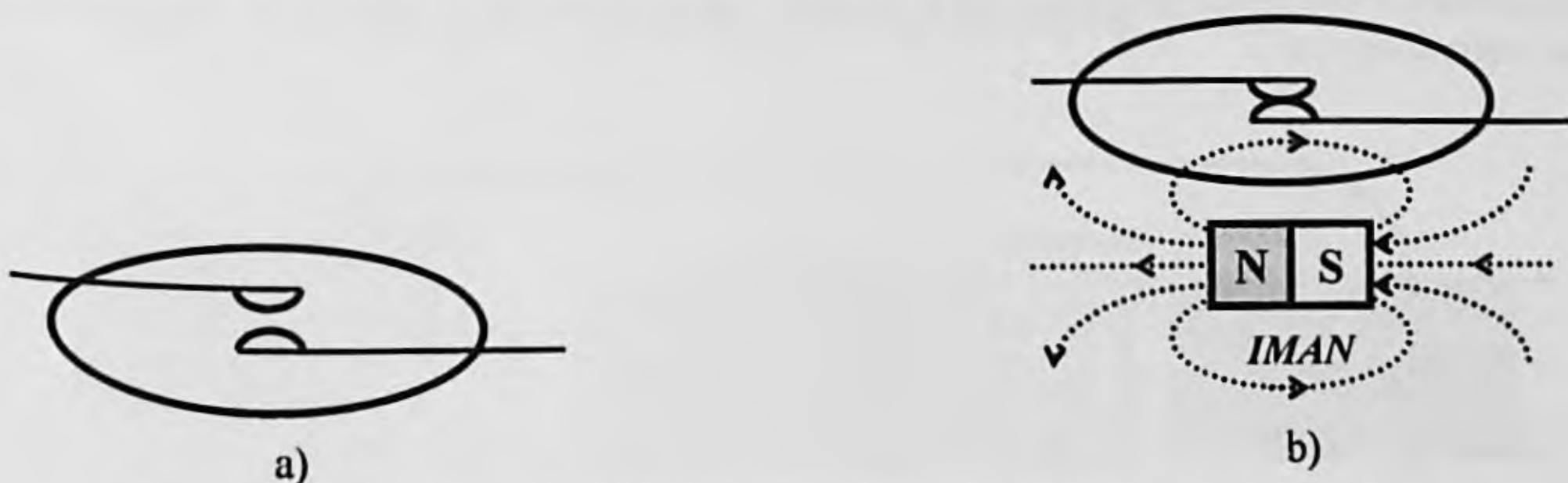
Figura 7.119 Funcionamiento de un sensor de proximidad magnético: a) Sin aplicar un campo magnético; b) Al aplicar un campo magnético.
