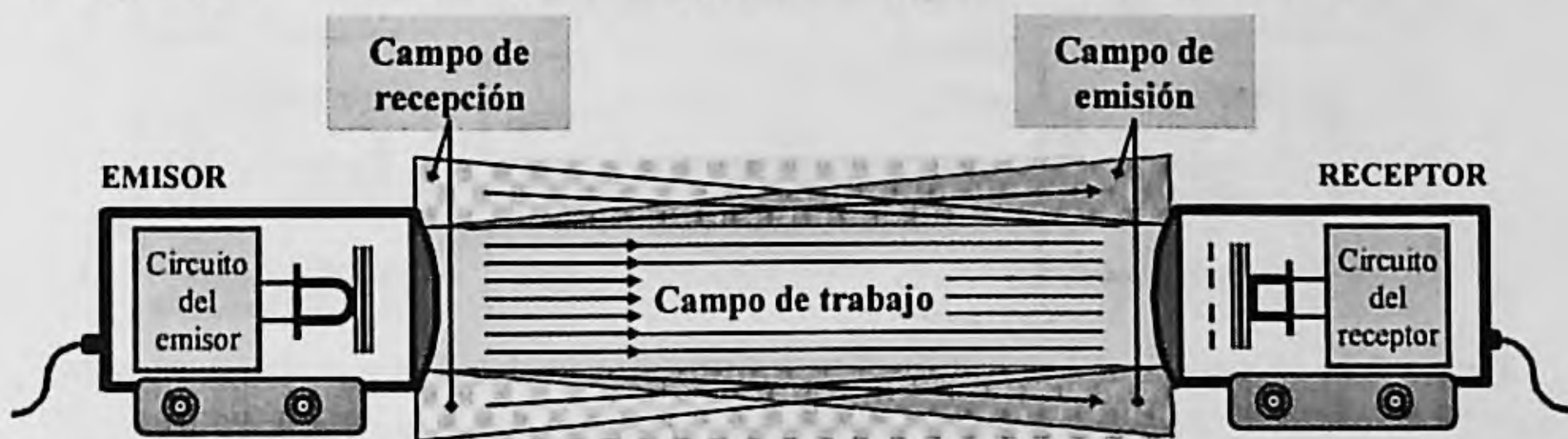
Figura 7.84 Campo de trabajo de la fotocélula de barrera de luz.
