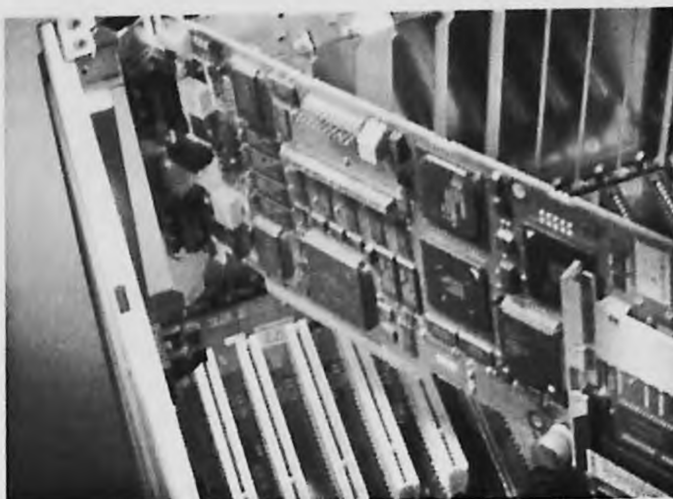
Figura 9.18. Arquitectura PC-PLC realizada con un computador industrial y una placa de autó-mata programable (Slot-PLC): a) Representación gráfica del concepto Slot-PLC; b) Computador industrial de Siemens que incorpora una placa "WinAC Slot 412".
