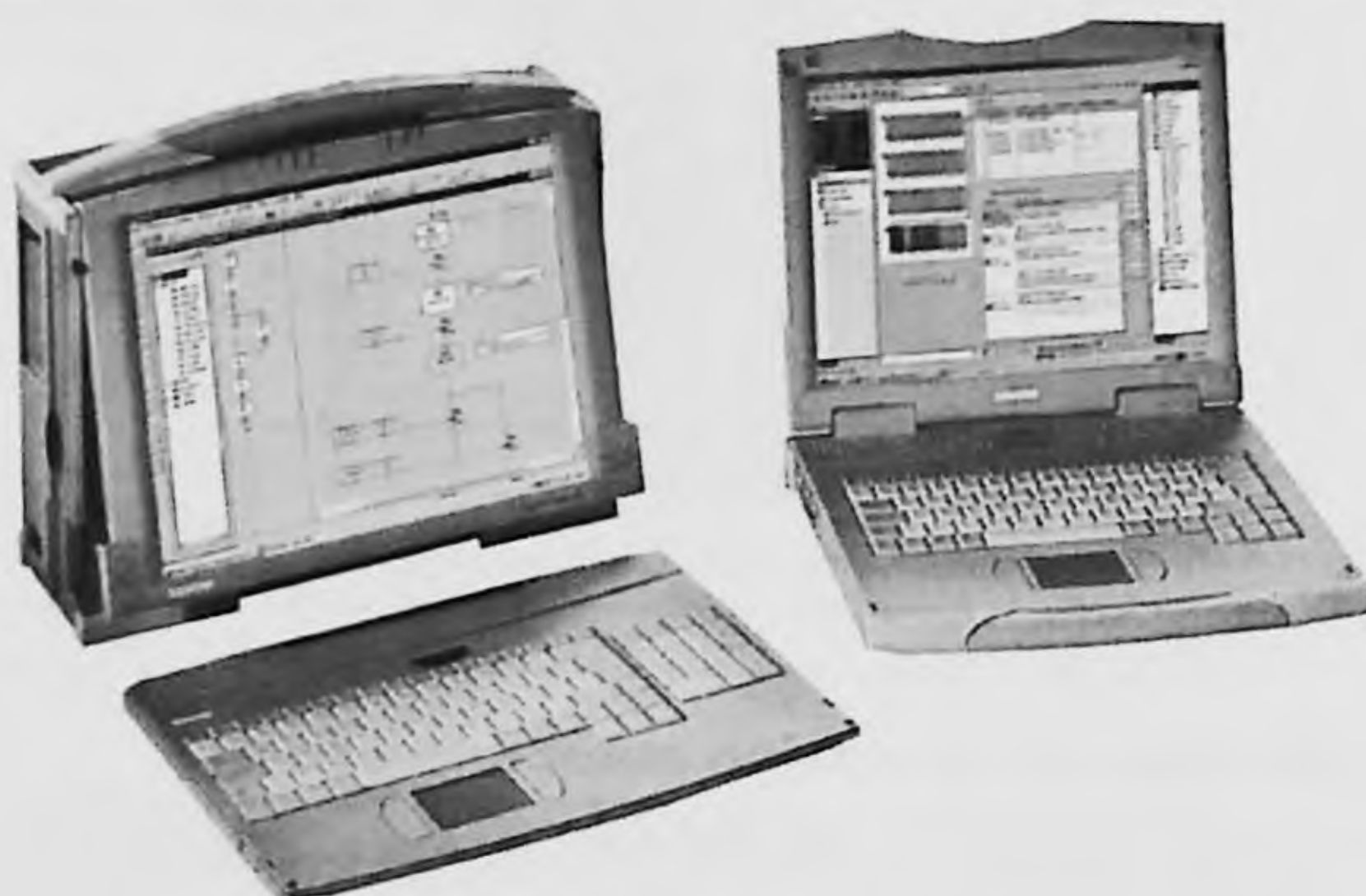
Figura 8.46. Unidades de programación Field PG PIII de Siemens.
