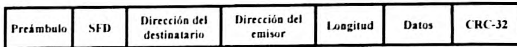
Figura A1.58. Trama de la subcapa MAC de acceso al medio de la norma IEEE 802.3 de la red Ethernet.
