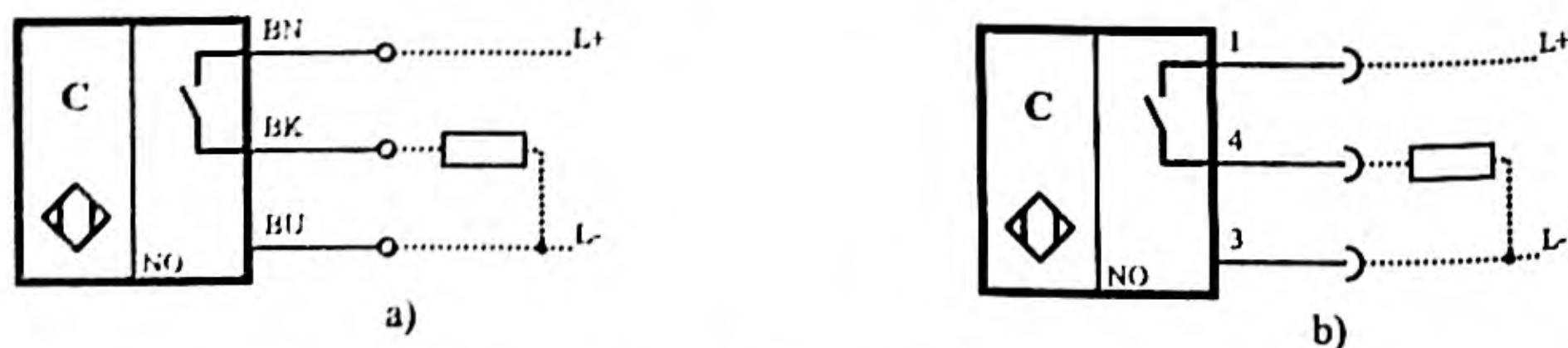
Figura 7.68 Símbolo de un sensor capacitivo polarizado de tres hilos implementado con un transistor PNP y equivalente a un contacto NO; a) Indicado con las letras de los cables; b) Indicado con los números de los terminales.
