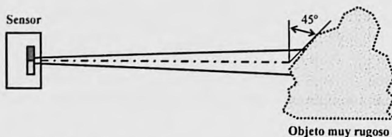
Figura 7.181 Efecto de la inclinación de un objeto muy rugoso sobre una señal ultrasónica.
