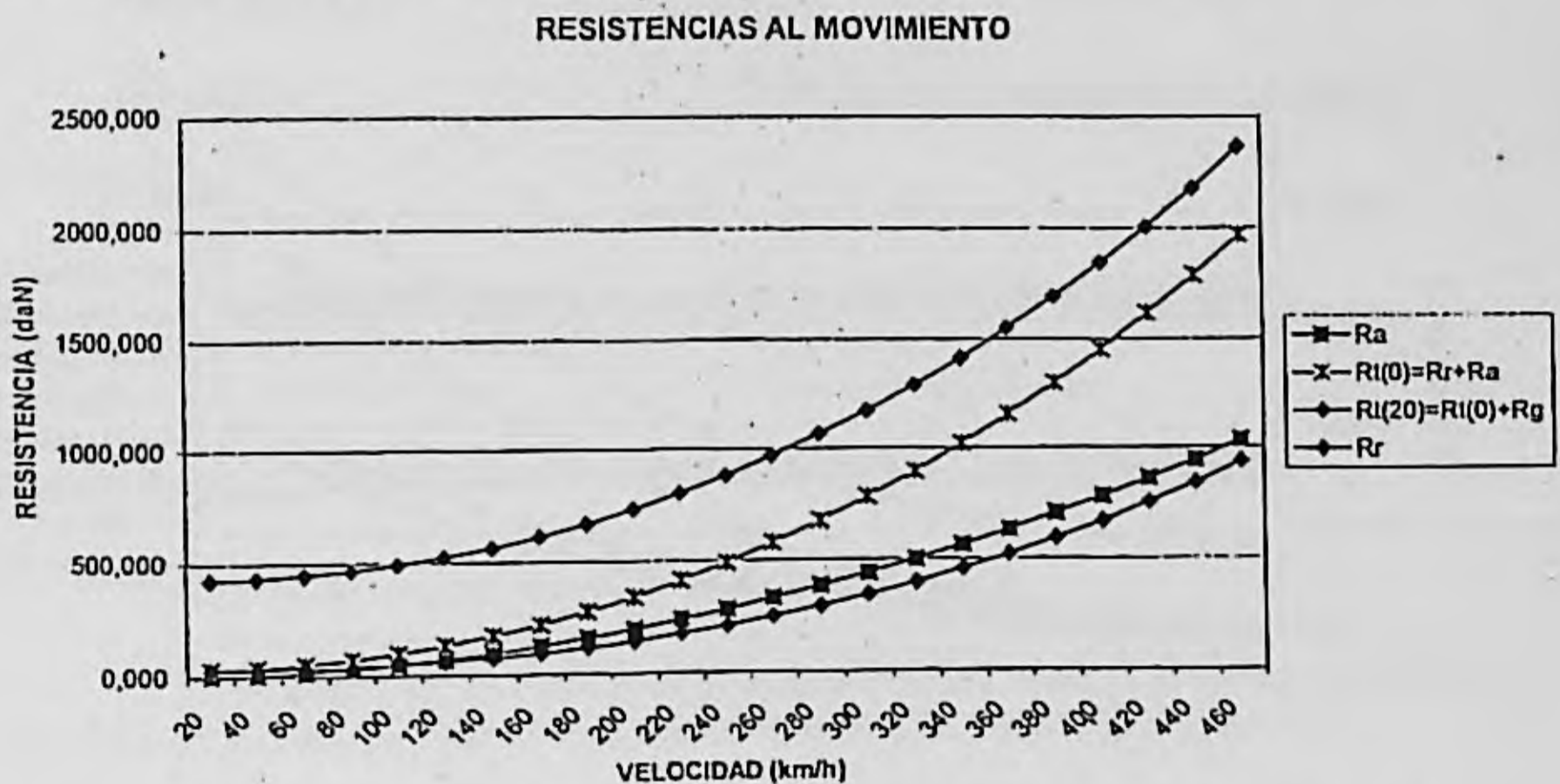
Figura 4.28(a). Valores de la resistencia al movimiento en función de la velocidad.
