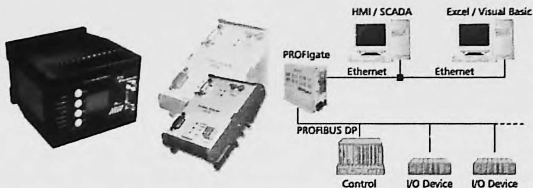
Figura A3.25. Pasarelas entre PROFIBUS y redes de datos industriales. (Cortesía de Bihl&Wiedemann, COMSOFT y Softing).
