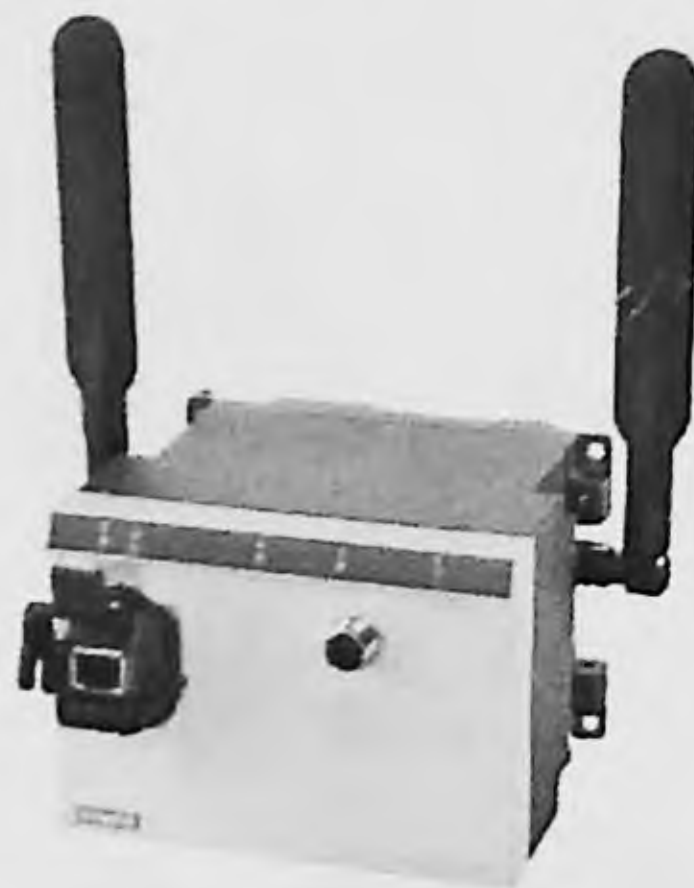
Figura A4.7 Conmutador inalámbrico (Wireless) SCALANCE W788 equipado de una interfaz a una red Ethernet inalámbrica y a una red Profinet.
