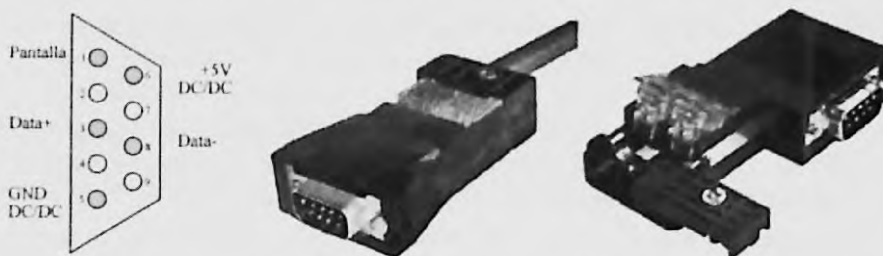
Figura A3.5. Asignación de terminales del conector Sub-D de 9 terminales. Diferentes versiones comerciales de conectores PROFIBUS (cortesía de Siemens).
